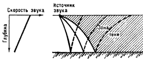
Рис.16. Рефракция звуковых лучей при уменьшении скорости звука с глубиной (отрицательная рефракция).
